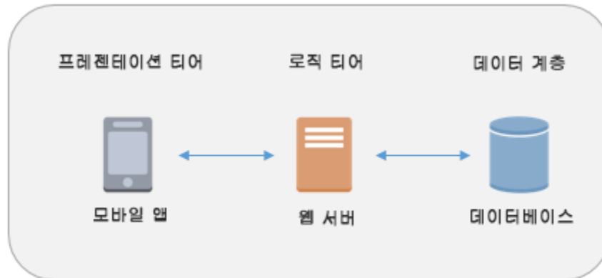
그림 1: 간단한 3티어 애플리케이션의 아키텍처 패턴
